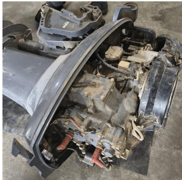
Gambar 2 Kondisi Motor Tempel Setelah Terendam
