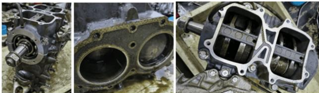
Gambar 6 Kondisi Blok Mesin Setelah Reparasi
