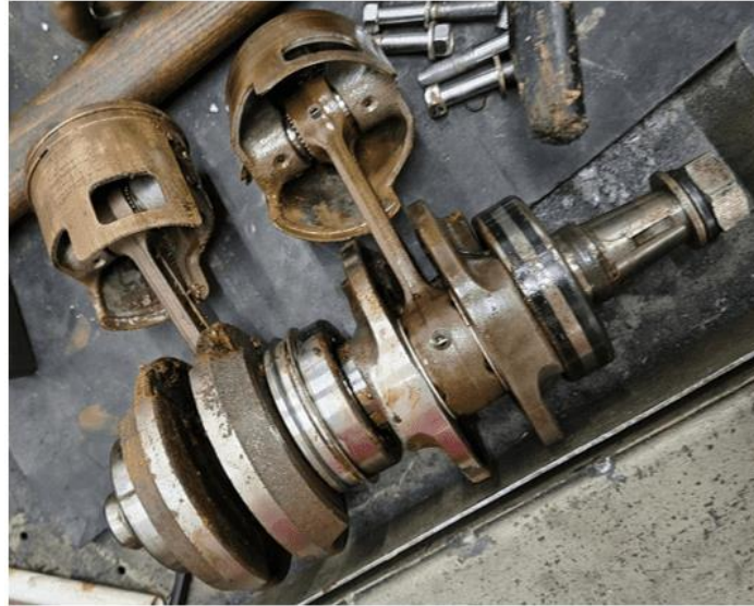
Gambar 5 Kondisi Crankshaft dan Piston Mesin Saat Pembongkaran
