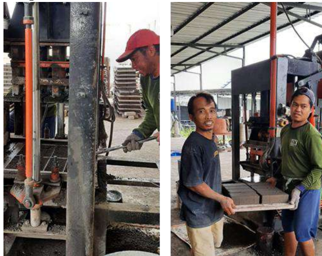
Gambar 11. Proses Pencetakan dan Pemandahan Hasil Pemadatan Paving Blok
