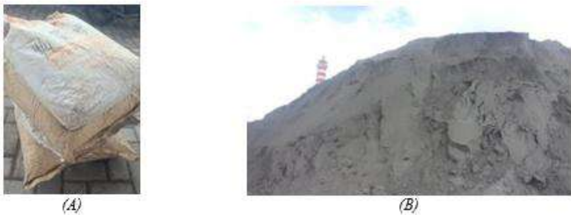
Gambar 1 (A) Fly ash dalam bantuk bag, (B) Fly ash dalam bentuk curah (Sumber: www.ekonomi.republika.co.id , 2024)
