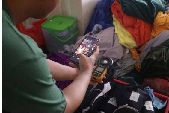
Gambar 3 Proses Pengukuran Pencahayaan
