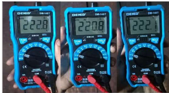
Gambar 7 Pengukuran Tegangan Setelah Pemasangan Pintu Air
