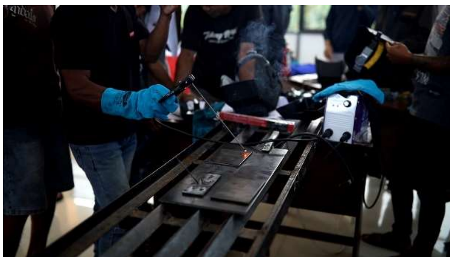
Gambar 3. Praktik pengelasan awal pada pelat
