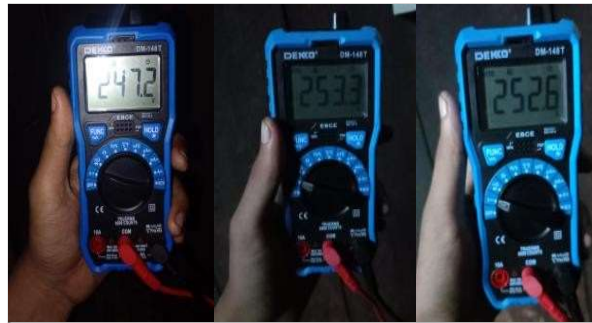
Gambar 6 Pengukuran tegangan pengambilan data awal
