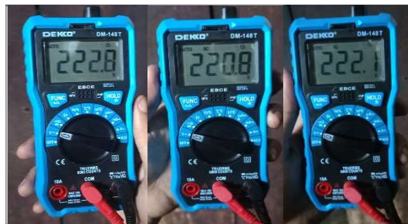
Gambar 7 Pengukuran Tegangan Setelah Pemasangan Pintu Air
